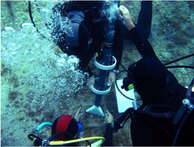
Campionamento della fauna vagile con sorbona ad aria
